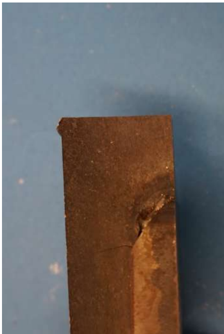
Abb. 5-25: Rissenstehung E 2-5 (li.) und E 2-3 (re.) [21]
