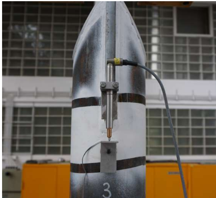
Abb. 5-11: Wegaufnehmer am Beispiel des Versuchskörpers E 3-1 [21]
