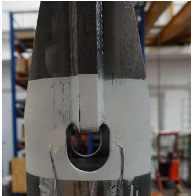
Abb. 5-7: Dehnmessstreifen am Freischnitt am Beispiel des Versuchskörpers E 1-1 [21]
