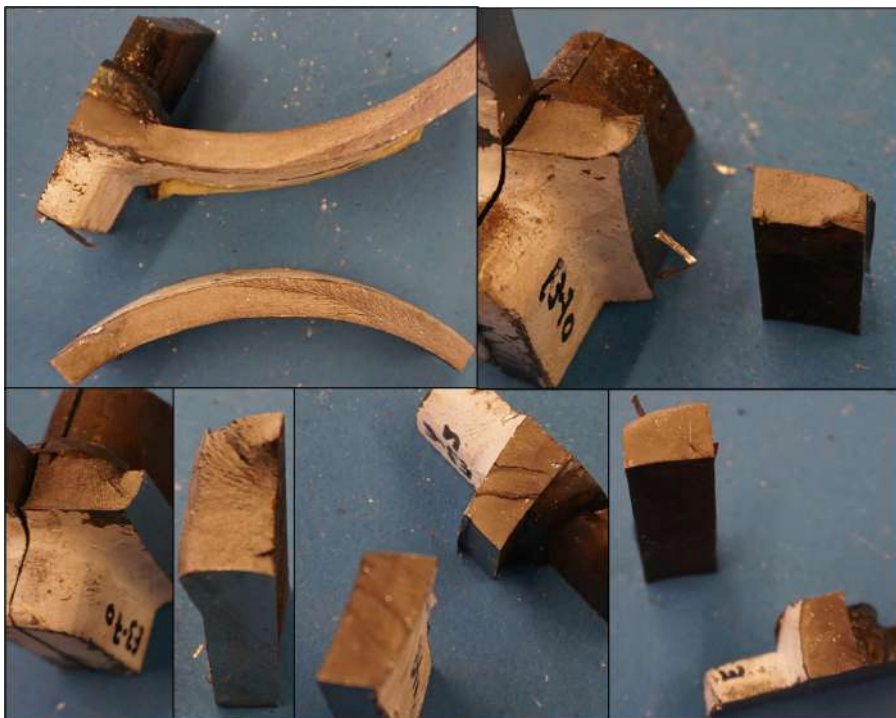
Abb. 5-27: Bruchflächen der Prüfkörper von Versuchsserie 3 [21]
