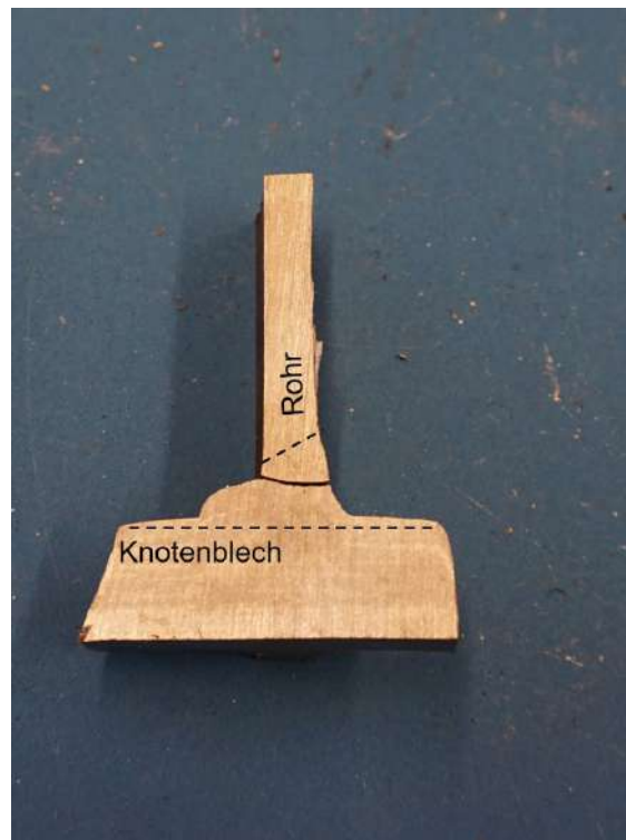
Abb. 5-28: Risswachstum des Versuchskörpers E 3-6 [21]
