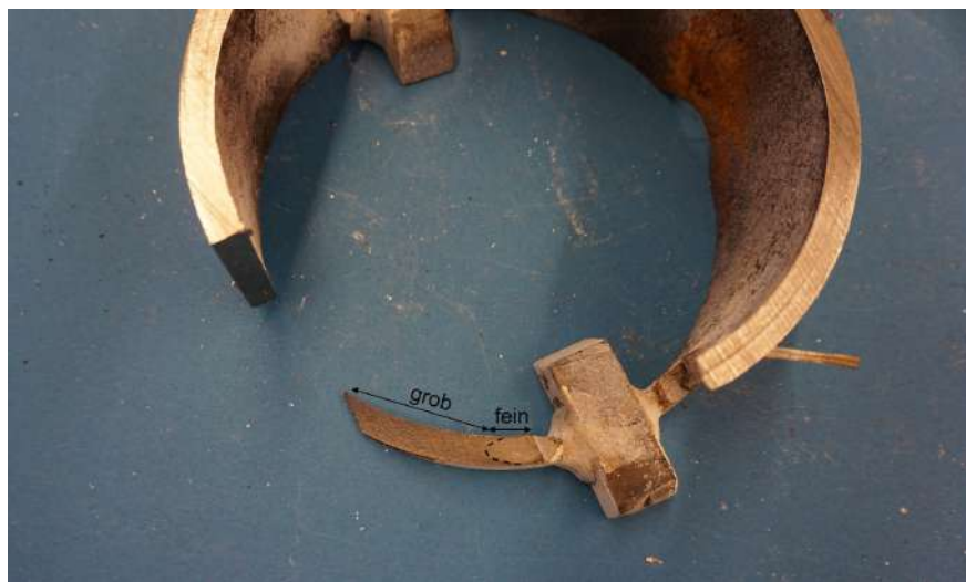
Abb. 5-21: Bruchfläche des Versuchskörpers E 1-3 [21]
