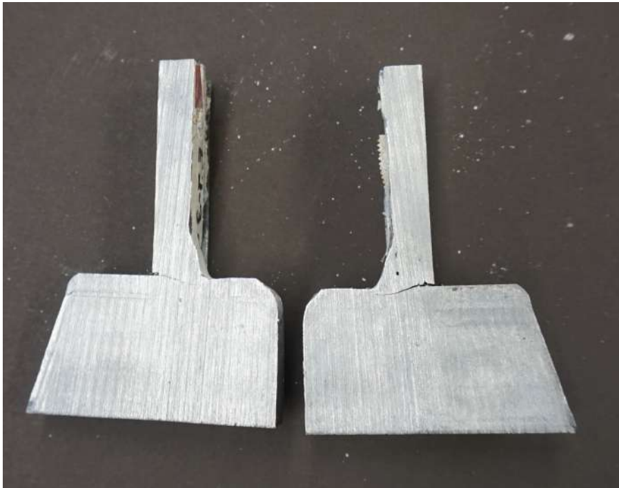
Abb. 5-23: Rissentstehung und Risswachstum des Versuchskörpers E 2-3 [21]
