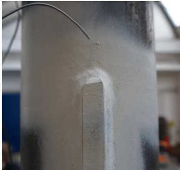
Abb. 5-9: Dehnungsmessstreifen an der Knotenblechendschweißung am Beispiel des Versuchskörpers E 2-7 [21]
