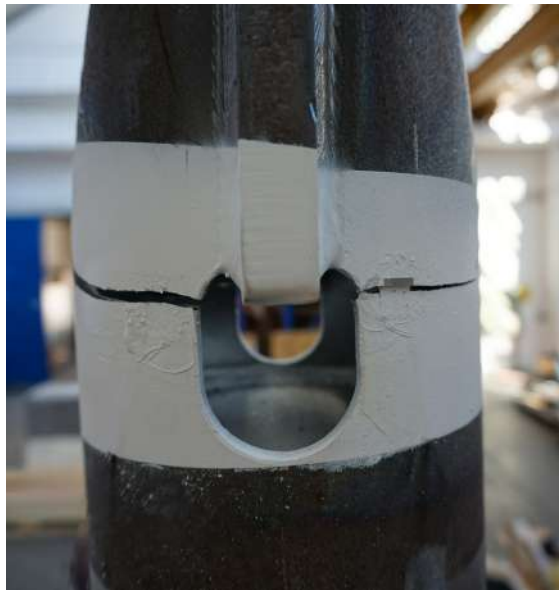
Abb. 6-5: Ort der Rissentstehung am Beispiel des Versuchskörpers E 1-5 [21]
