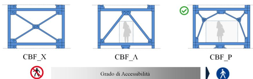
Figura 35: Scelta tipologica (Liv.III\_a): configurazione delle aste di parete per i CBF.
