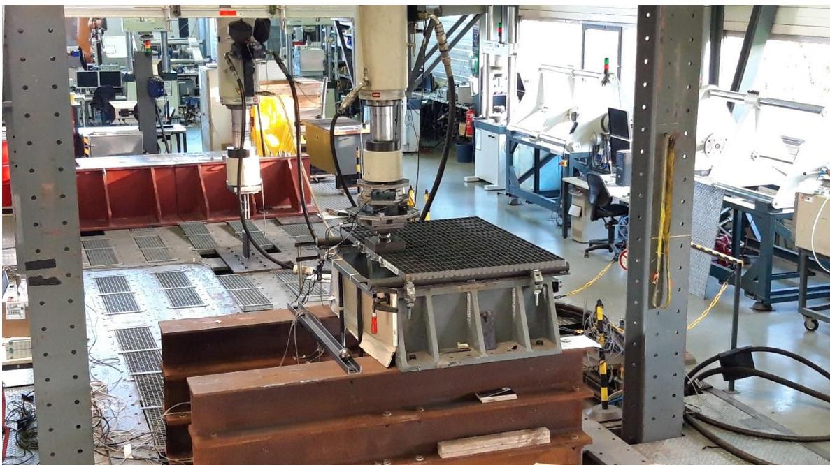
**Abbildung 3-7: Ansicht des gesamten Versuchsstandes für die Gitterrostplatten**
