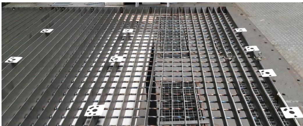
**Abbildung 3-11: Angebrachte Messmarken und magnetische Haken zur Wegmessung**
