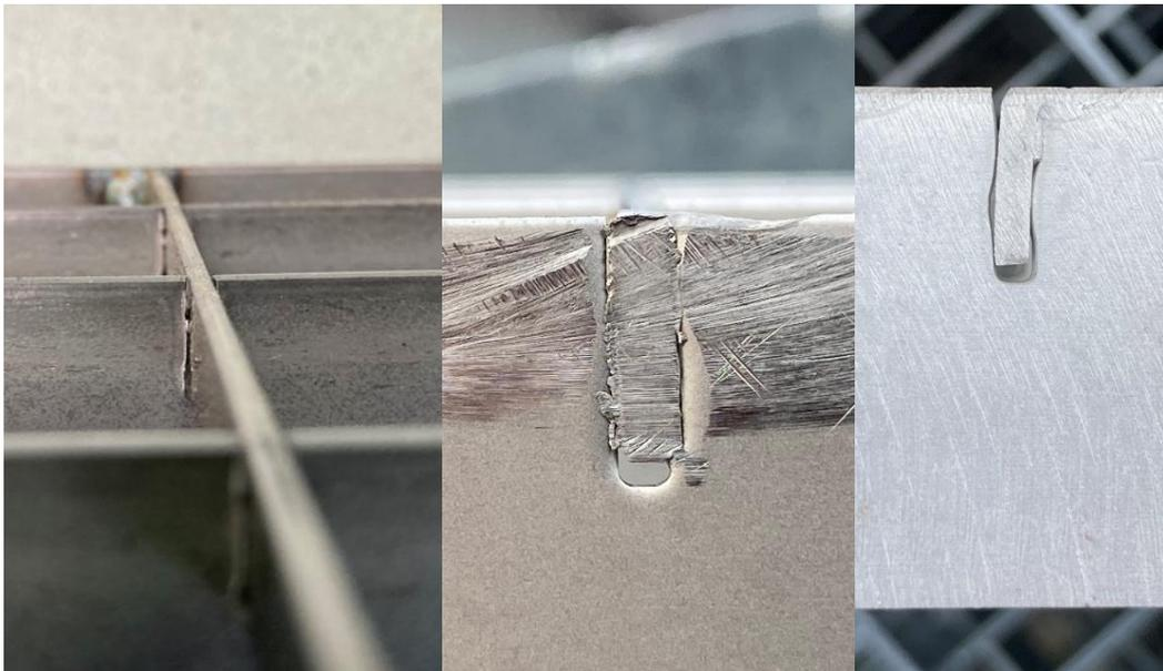
**Abbildung 4-8: Schlitzungen der Gitterroste aus unverzinktem Baustahl, Edelstahl und Aluminium**
