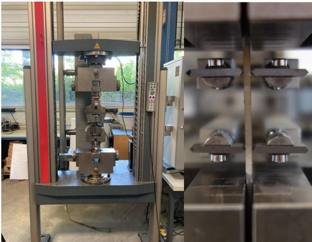
Abbildung 3-2: Versuchsaufbau für die Zugproben (links) und Seitenansicht einer Zugprobe (rechts)
