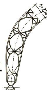
Rys. 1.27. Pawilon wystawowy w Mediolanie: a) schemat łuku, b) fragment skratowania łuku [5]
