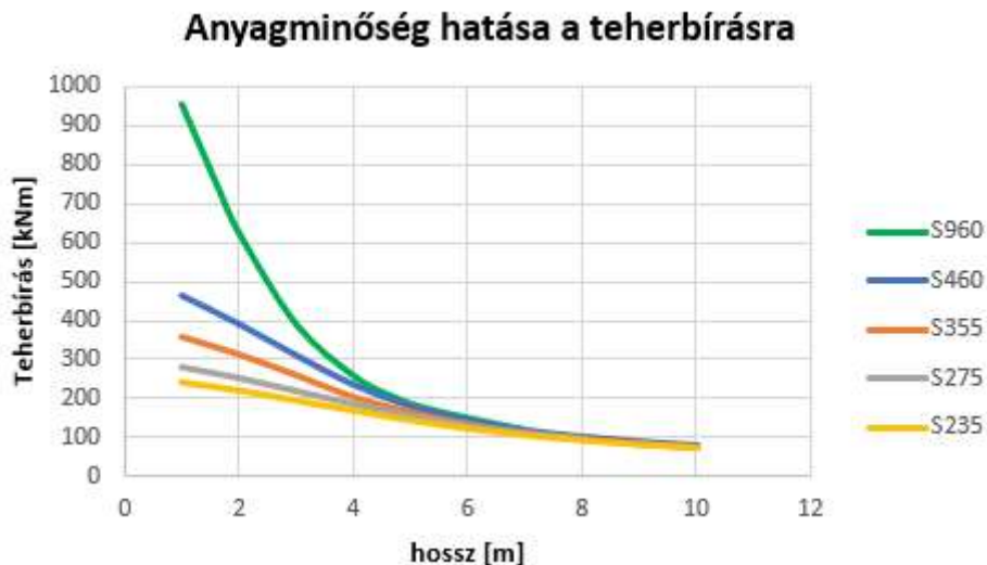
62. ábra: Az anyagminőség hatása a kifordulási ellenállásra.
