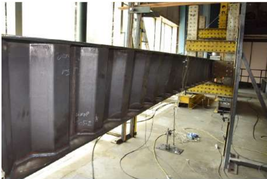
22. ábra: 1/1 próbatest kifordulás vizsgálata (BME – 2019).
