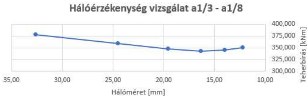
38. ábra: Hálóérzékenység vizsgálat eredménye.
