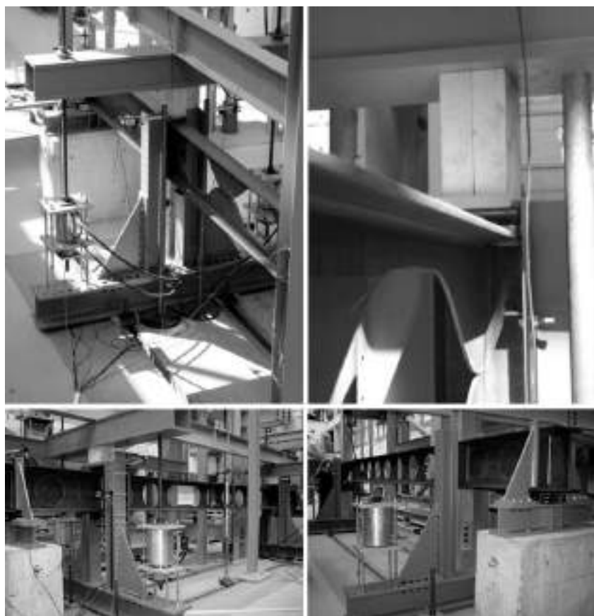
Figura 2.10 – Ensaio de flexão de 4 pontos em vigas alveolares
